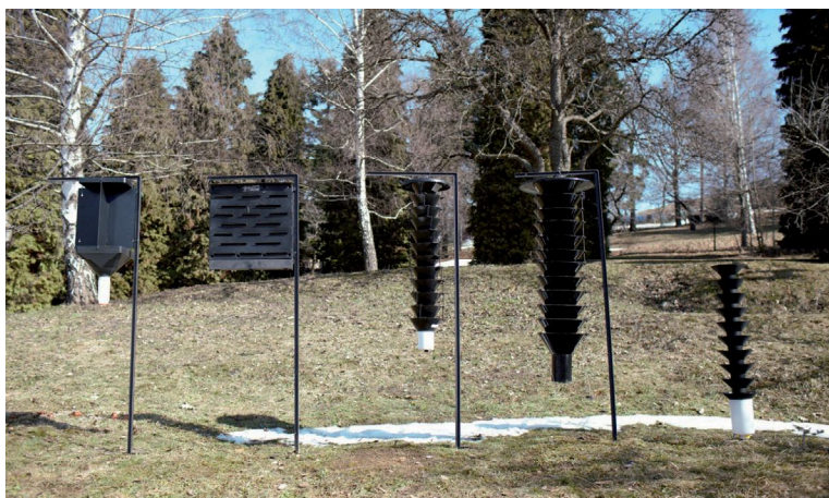
Obrázok 10. Rôzne konštrukčné typy feromónových lapačov na podkôrny hmyz: (zlava) Ekotrap, Teysohn, Lindgren funnel trap, Experimentálny prototyp, BEKA trap
