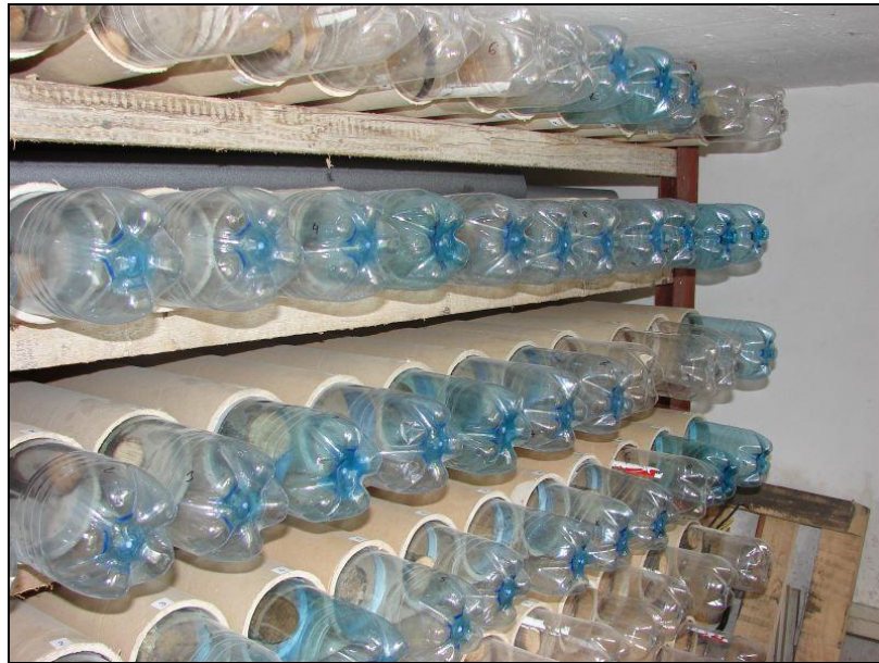
Obr. 5 Zostava rúrových fotoeklektorov. (Foto: Galko)
