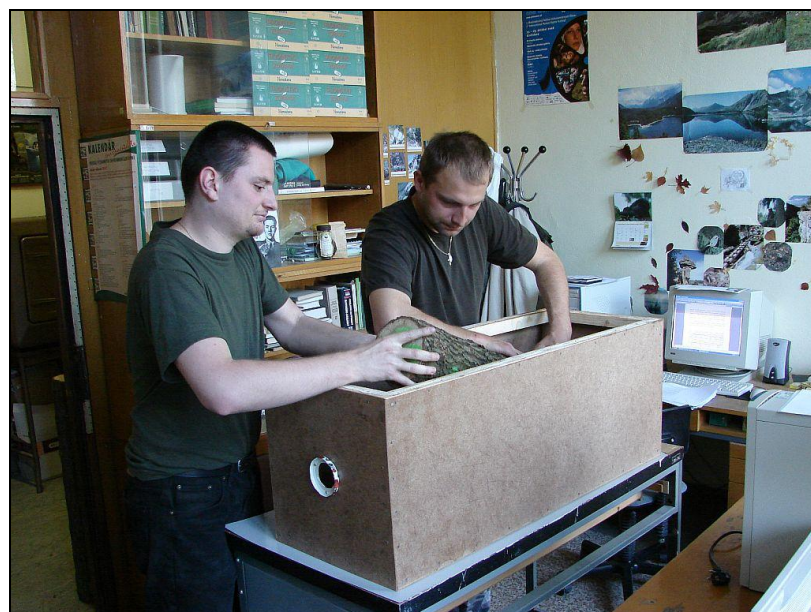
Obr. 2 Krabicový fotoeklektor ó vkladanie vzoriek. (Foto: Galko)
