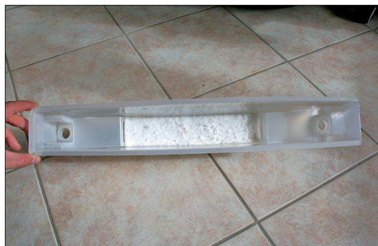
Obrázok 2. Inokulačná vložka s Boverolom v zbernej nádobe lapača Multiwit BK
