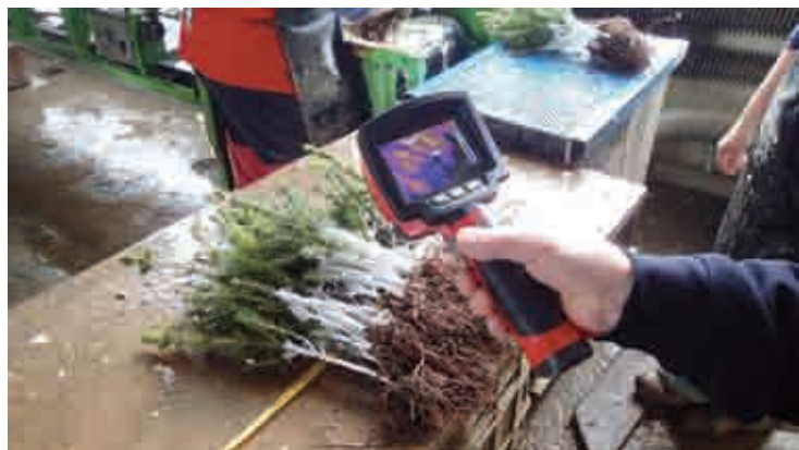
Obrázok 2. Meranie teploty voskovaných sadeníc po schladení pomocou termokamery
