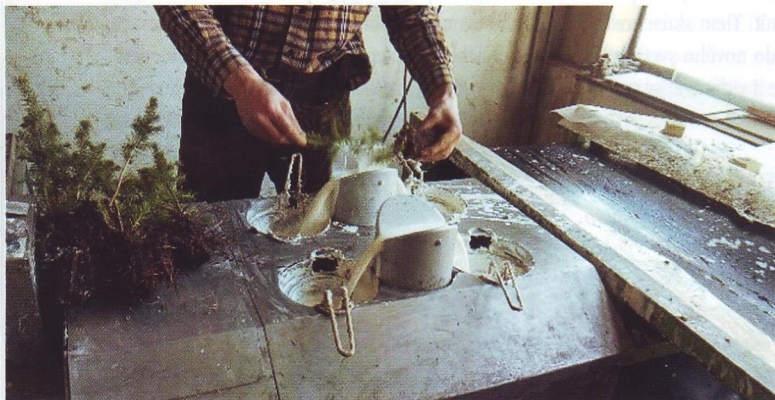
Voskovacia linka a detail pri voskovaní sadenice
