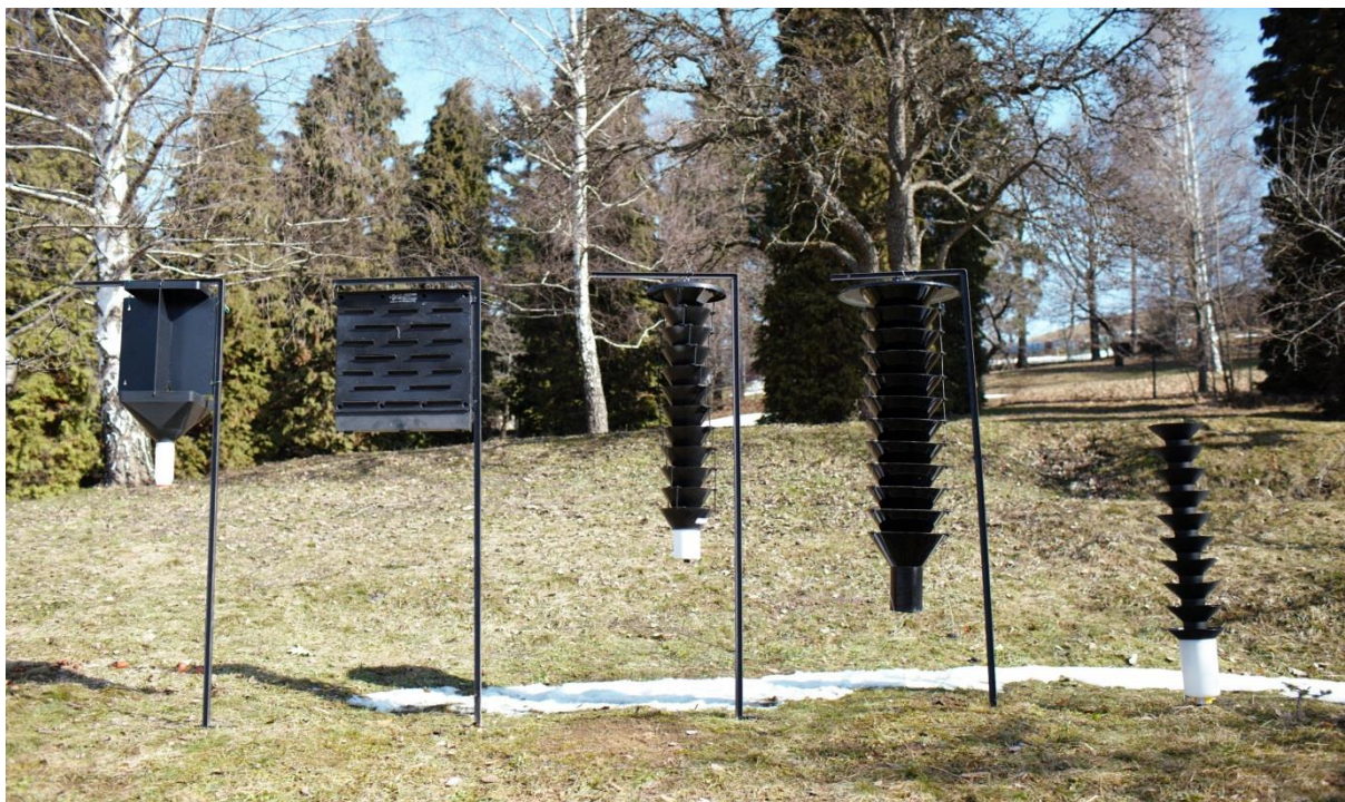
Obr. 7: Rôzne konštrukčné typy feromónových lapačov na podkôrny hmyz: (zľava) Ecotrap, Theysohn, Lindgren funnel trap, Experimentálny prototyp, BEKA trap.
